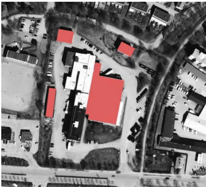
De delar av befintliga byggnader som kommer att rivas. Den påtagliga tillbyggnaden i söder (mörkt tak) från 1955 med klassiska klockan på södra gavelns tak bevaras.
