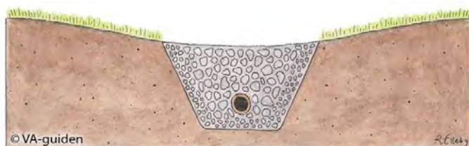
Figur 18. Till vänster: Principskiss av ett makadamdike uppbyggt med dräneringslager med makadamfyllning, övergångslager, matjord och gräs (Illustration: VA-guiden). Till höger: Exempel på ett infiltrationsstråk vid en parkeringsyta (Bild: VA Syd).
