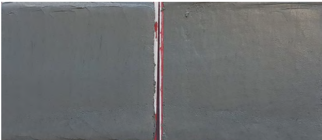
Figur 4 Borrpunkten, 22W006, 8,0 m, Jordprovet i nedre delen av mellanhylsan delad longitudinellt provhylsan med id Bjerking 801.
