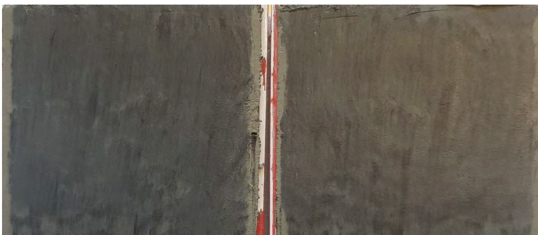
Figur 2 Borrpunkten, 22W006, 4,0 m, Jordprovet i nedre delen av mellanhylsan delad longitudinellt provhylsan med id Bjerking 695.
